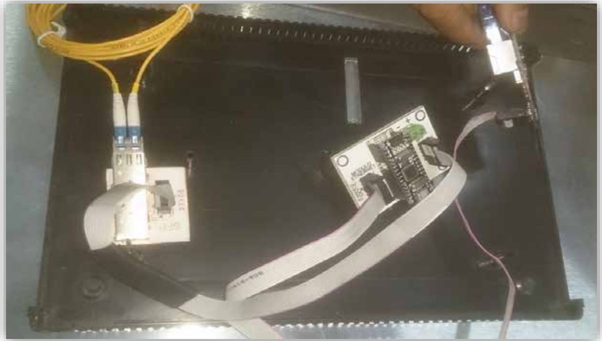
Figura N°55. Prototipo de OTDR en Plataforma Arduino Fuente: Solórzano, 2017
