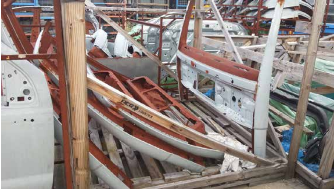
Figura 5. Material que no puede ser retrabajado (Scrap)
