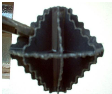
Figura 6 Biopelícula Suspendida después de ser Introducida Al Reactor Fuente: Dugarte C. y Ulacio Luis. (2021)
