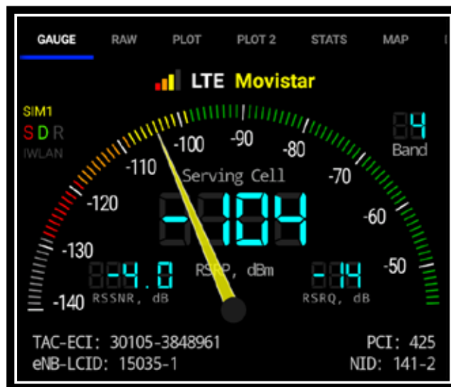
Figura 44. Medición con Movistar en Network Cell. Fuente: Network Cell.
