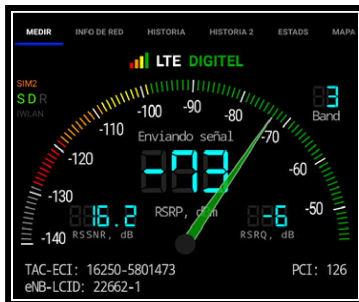
Figura 32. Medición con Digitel en Network Cell Info.
