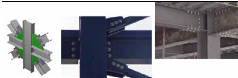
Figura 45: Detalle de Uniones (2017)
