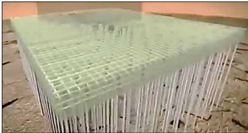
Figura 50: Pilotes Hincados amarrados a la Losa Maciza (2017)
