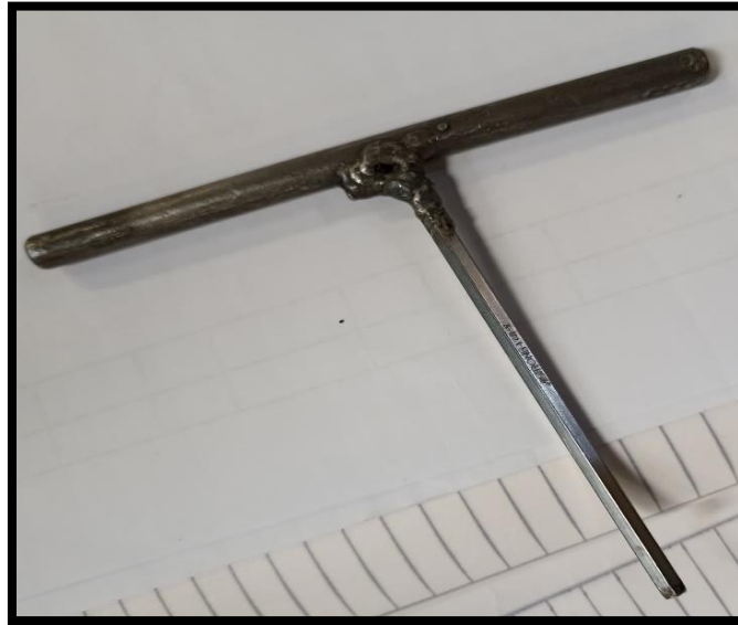
Figura 21. Llave Allen mal fabricada Autores: Aponte, A y González, P.
