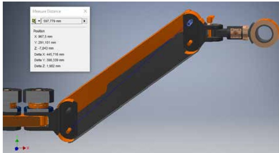
Figura 48. Distancia de separacion entre pasadores de cilindro
