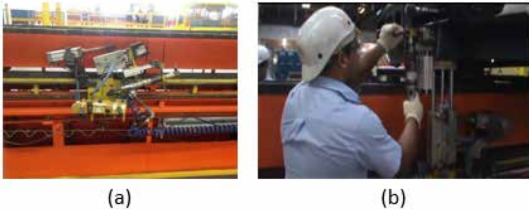
Figura 42. Manipulador de herramientas de ajuste por encima del hombro, (a) Estado de reposo, (b) Siendo utilizado
