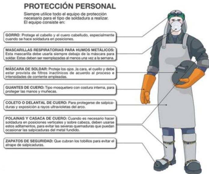
Figura 21 Protección personal para área soldadura Fuente: Starcargas (2018)
