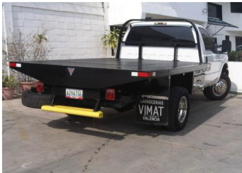
Figura 4 Plataforma 3m con defensa sin forrar
