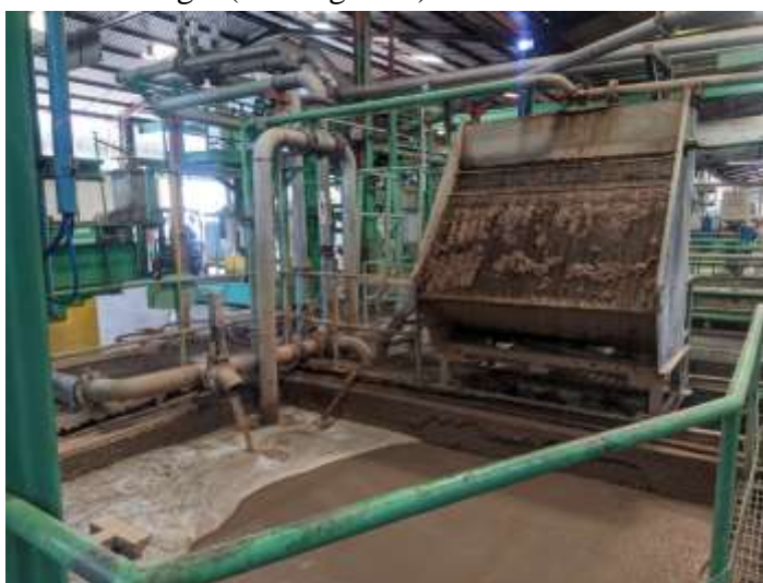
Fig. 6, Registro Fotográfico de la tina para medir las consistencias de la pulpa.
