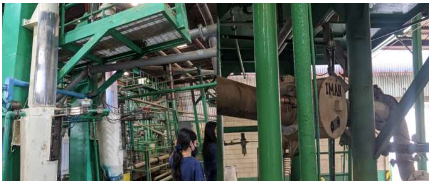
Fig. 7, Registro Fotográfico de Maquina de centrifugado para quitar los residuos más pequeños como partículas de arena, plástico, etc. Y del Imán por dónde pasa la pulpa para quitar todo aquel desecho metálico.
