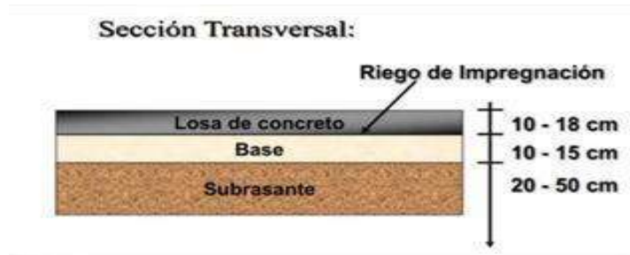
Figura 10. Estructura del pavimento rígido
