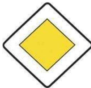
Figura 24. Señalización “Calzada con Prioridad”
