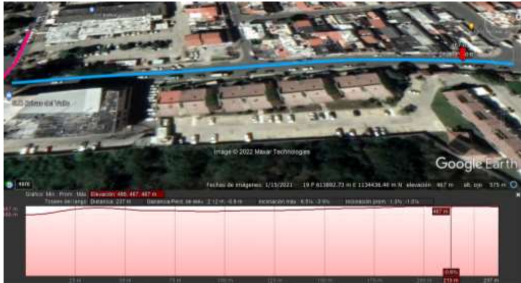
Figura 70. Perfil Longitudinal del tramo Intersección 1 (Inicio-Final)
