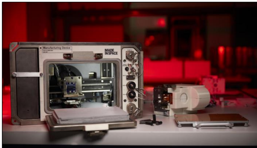
Figura 3: Impresora Redwire Regolith Print (R.R.P) Fuente: NASA Ciencia (2021)
