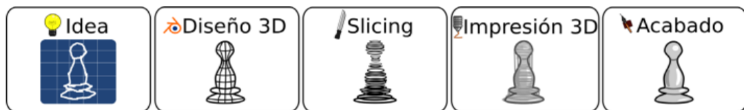
Figura 14: Proceso de impresión 3D. Fuente: Bordignon F, Iglesias A. y Hahn A. (2018)
