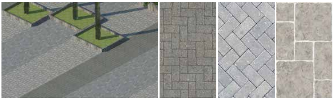
Figura 36: Piso de concreto texturizado/pigmentado (área de caminerías).
