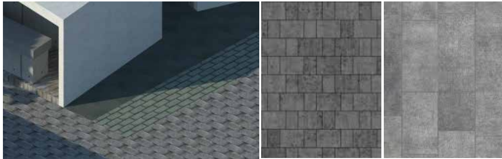
Figura 37: Piso de concreto texturizado/pigmentado (área módulos de venta temporal).
