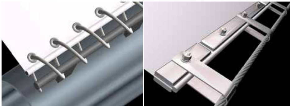
Figura 52: Detalle de sistema de anclaje por amarre tejido tradicional en acero (izq.) / correas de aluminio (der.)
