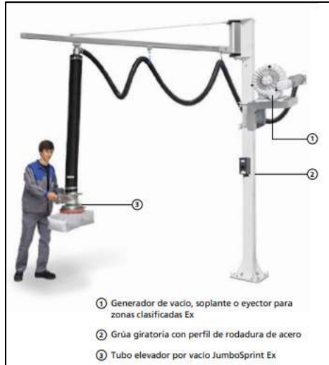
Figura 33: Tubo Elevador por vacío Jumbo Sprint. Fuente: Catálogo de empresa Schmalz (s.f).
