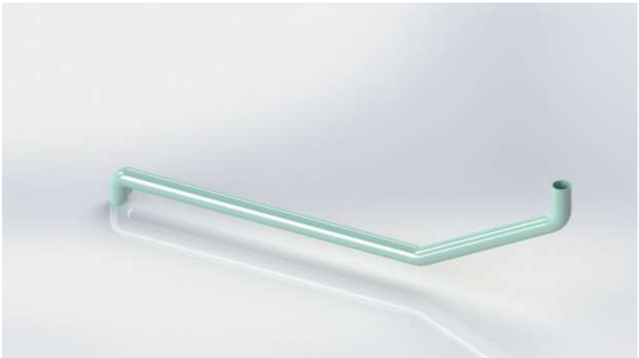
Figura 87: Tubo de bomba de vacío.
