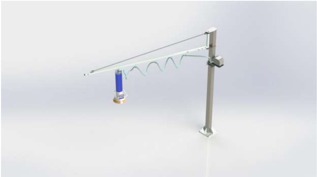
Figura 109: Ensamble del elevador por vacío Jumbo Sprint.
