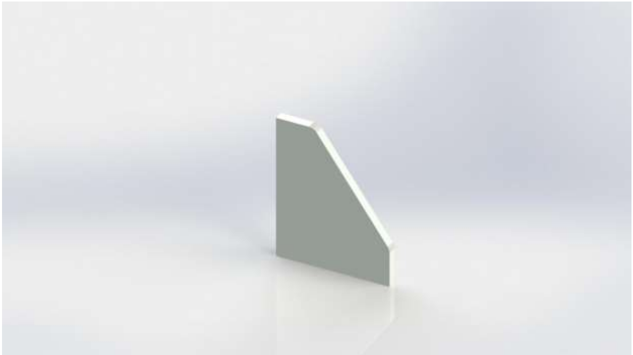
Figura 107: Aleta de refuerzo del empotramiento de la grúa.
