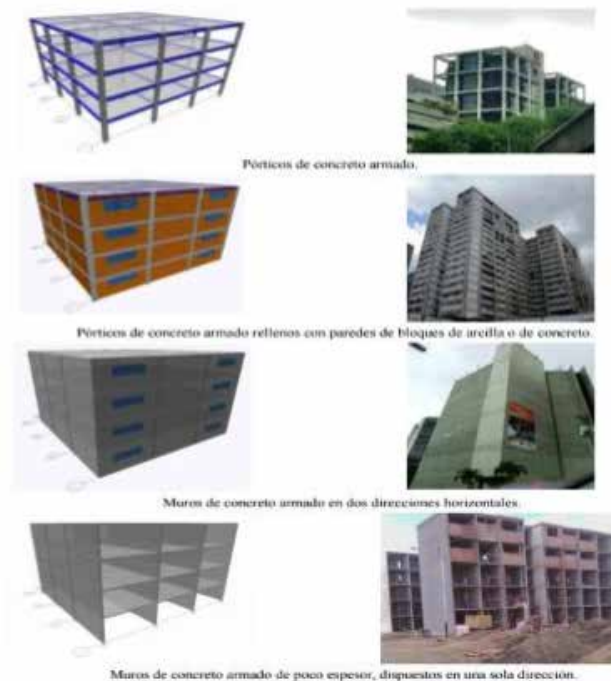
Figura 13. Tipo de estructura.
