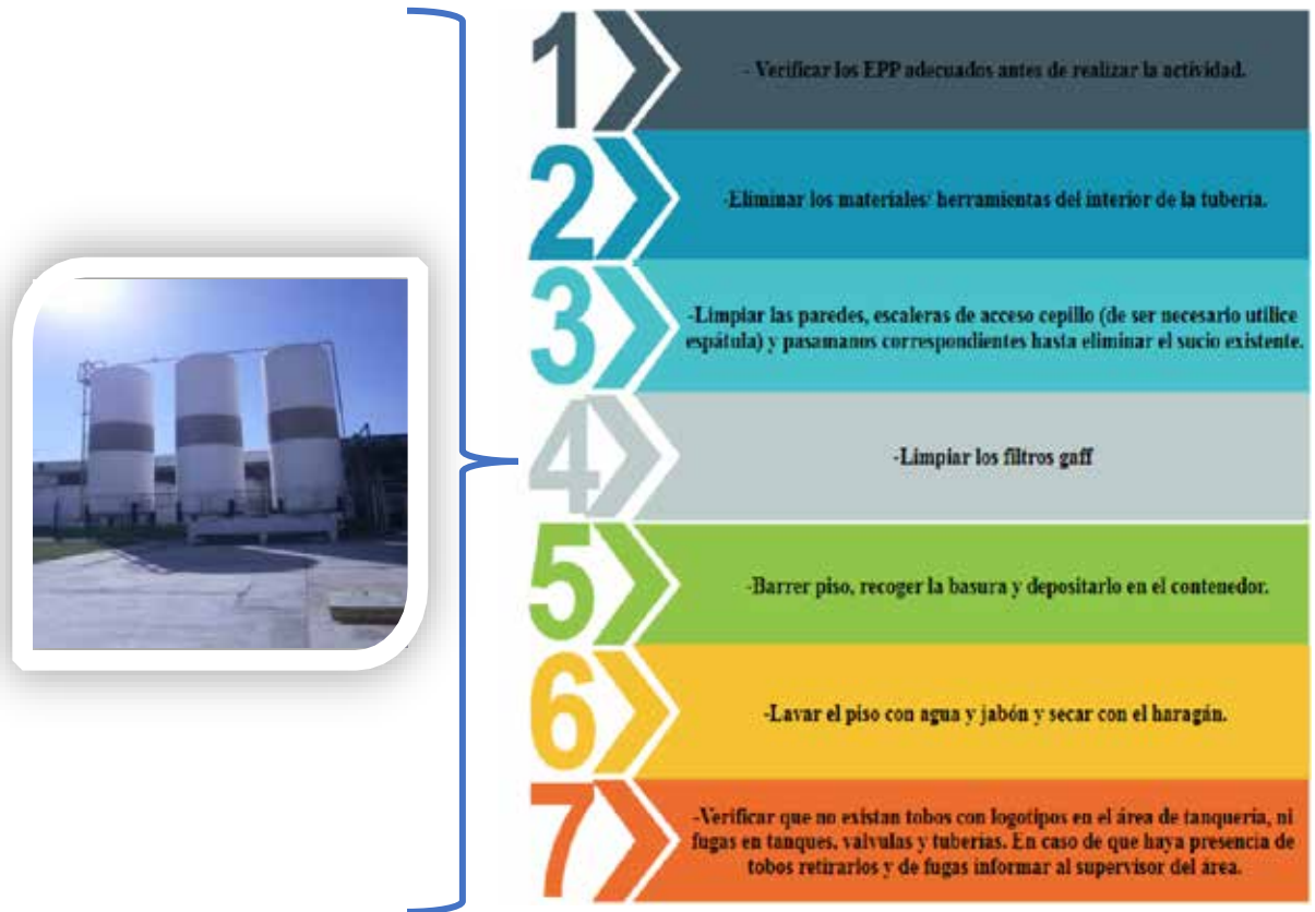
Figura 44: Proceso de Limpieza Tanquería PET 7004-7006
