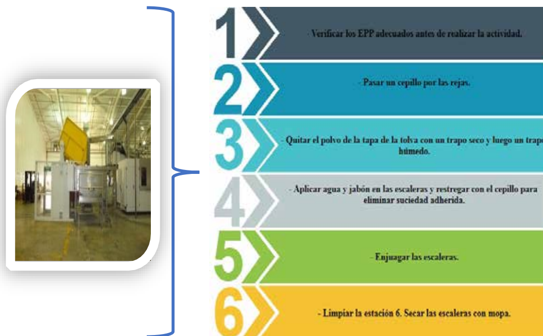
Figura 53: Proceso de Limpieza Tolvas de Preformas y Tapas
