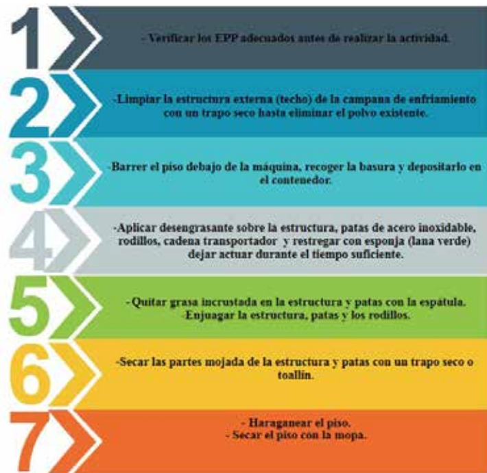
Figura 48: Proceso de Limpieza Campana de Enfriamiento
