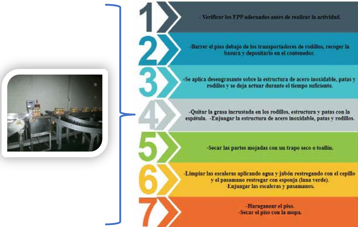
Figura 49: Proceso de Limpieza Desviador de Botellas
