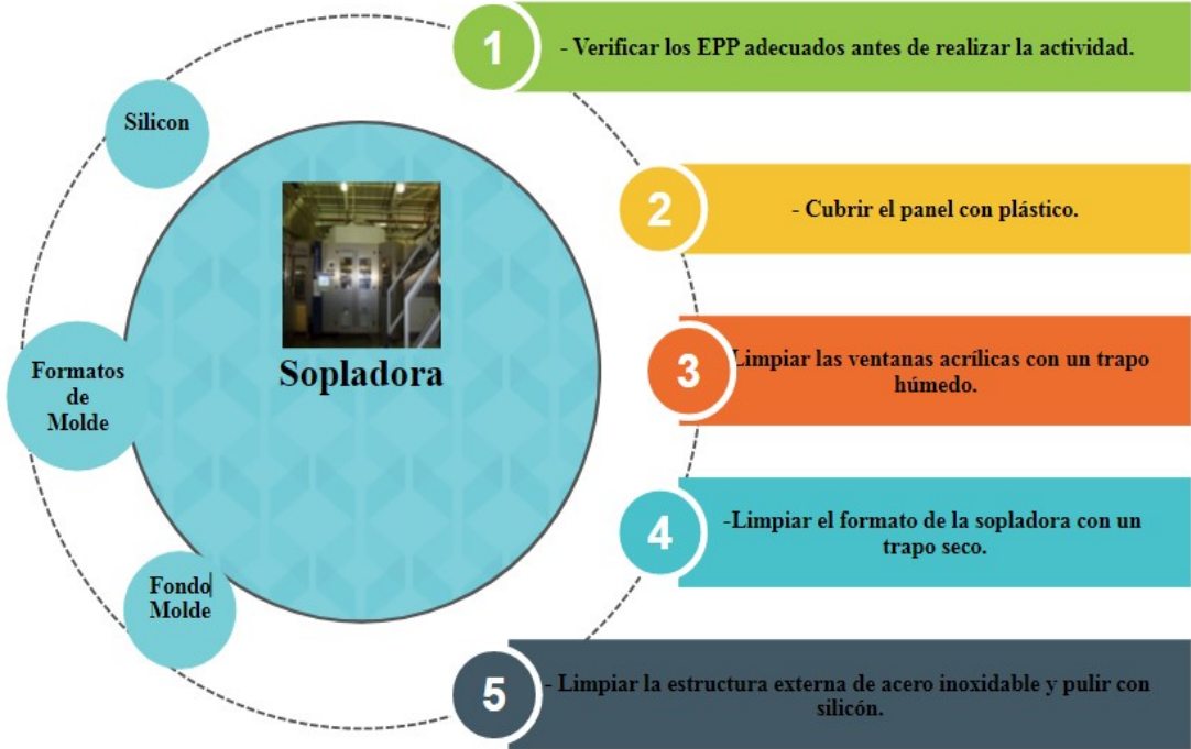
Figura 54: Proceso de Limpieza Sopladora
