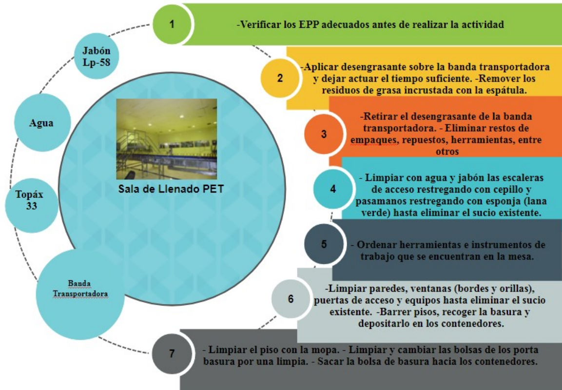
Figura 41: Proceso de Limpieza Estación Sala de Llenado PET
