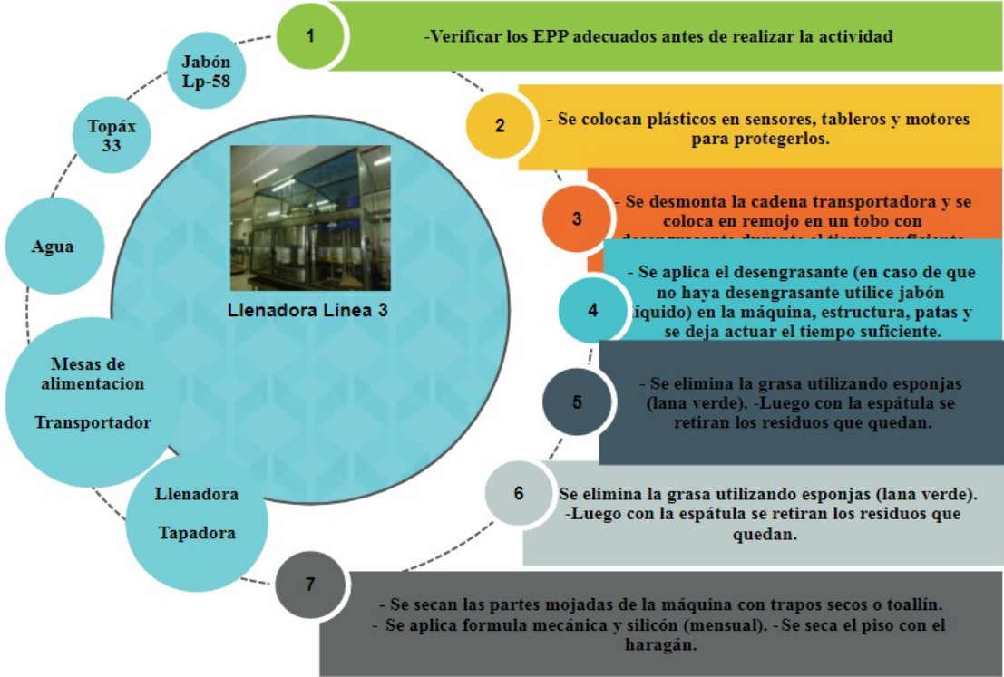
Figura 26: Proceso de Limpieza Llenadora Línea 3
