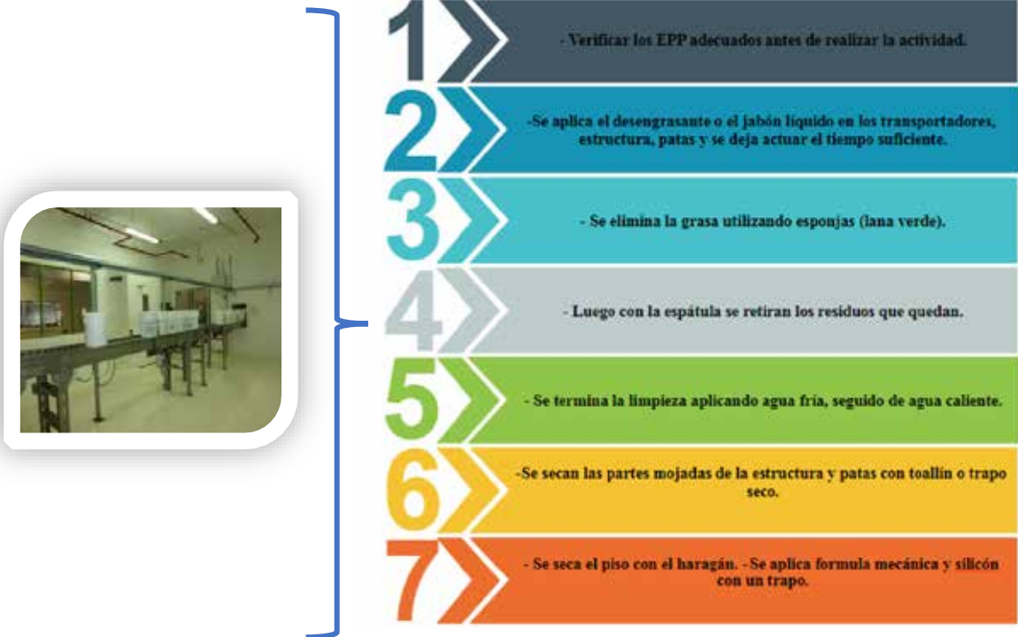
Figura 29: Proceso de Limpieza Transportadores Línea 3
