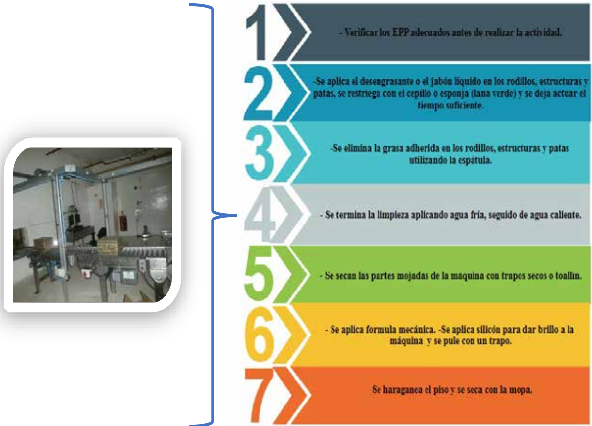
Figura 34: Proceso de Limpieza Transportadores Línea 4 (Manteca)
