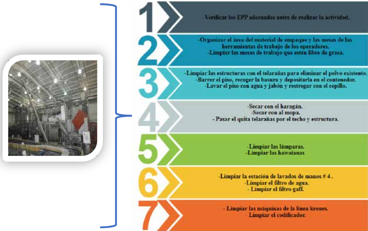
Figura 52: Proceso de Limpieza Sala de Llenado Línea 6 Krones
