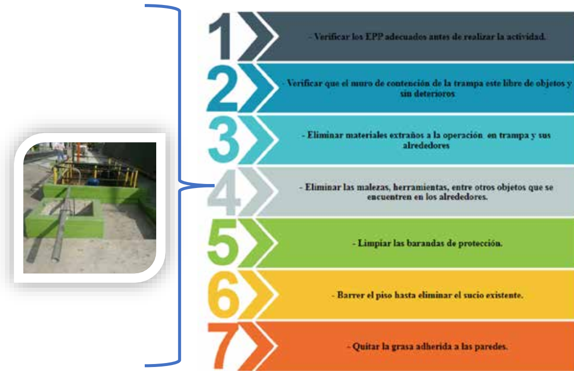
Figura 9: Proceso de Limpieza Trampa de Grasa
