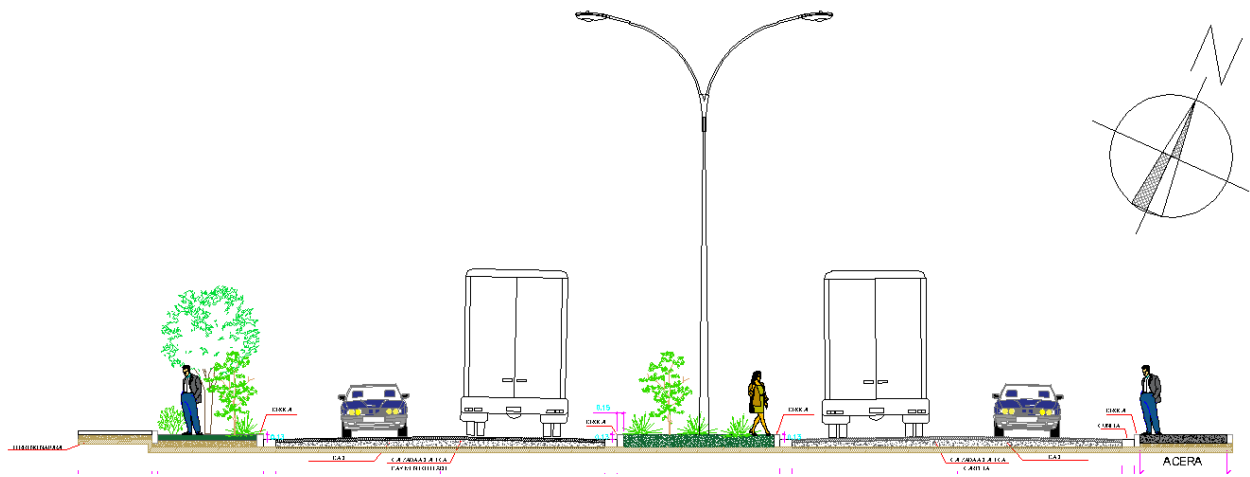
Figura 10: Sección Transversal Intersección.
