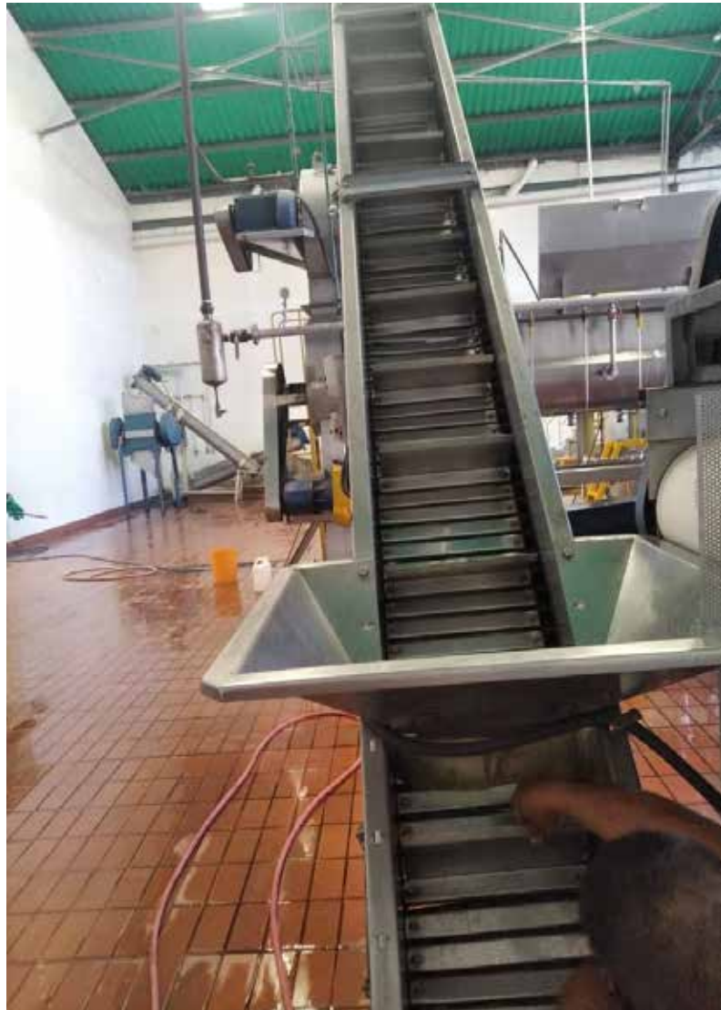
Figura 8. Elevador de cangilones. La falta de cangilones Fuente: Alimentos Congelados la Constancia C.A.
