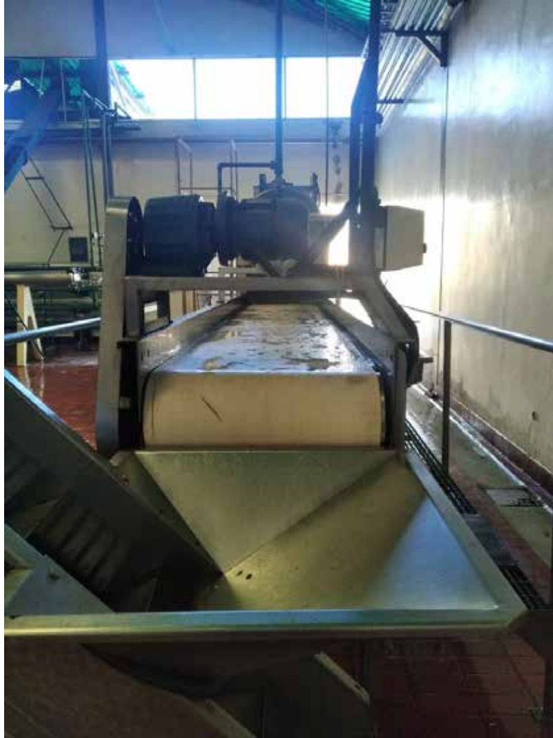
Figura 7. Estación de selección y alimentación: El elevador de cangilones.
