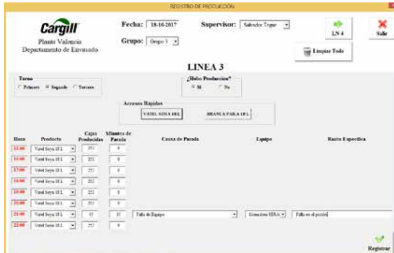
Figura 21. Ventana interactiva de reporte de producción y paradas (registro). Fuente: Elaboración propia.
