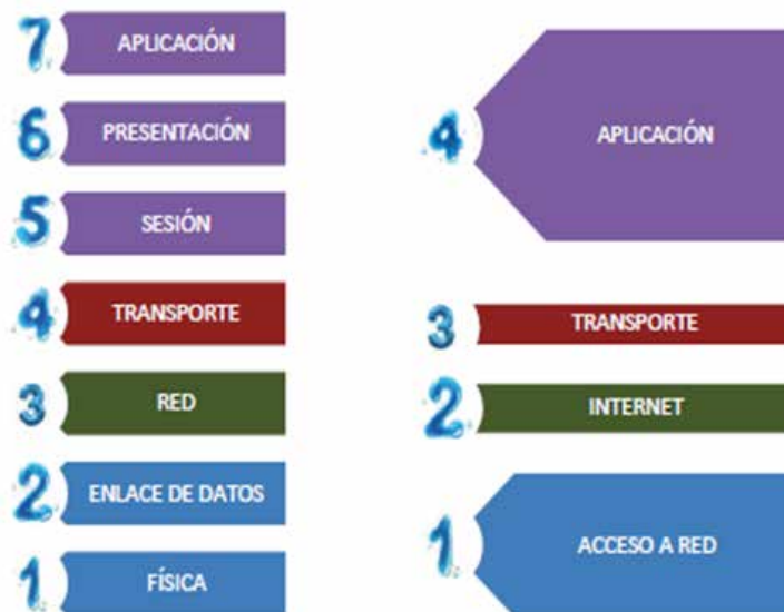
Figura 15. Modelo TCP/IP en relación al modelo OSI
