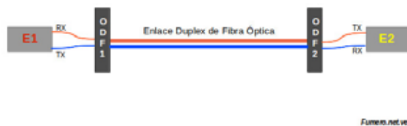
Figura 7: Trayectoria completa de transmisión entre el transmisor y el receptor
