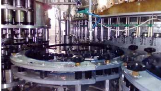
Figura 20. Estrella de salida de la llenadora.
