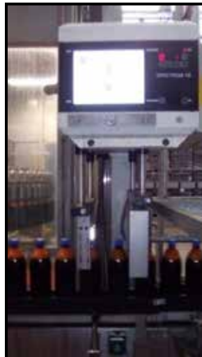
Figura 8. Inspector de botellas llenas de la línea 1 con corrida de Maltín Pet 1500 ml de Cervecería Polar, Planta San Joaquín
