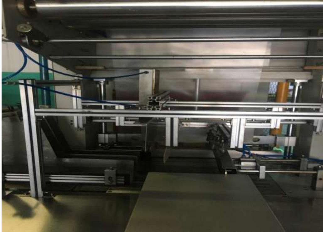
Figura 4: Interior de la máquina de embalaje donde se envuelve el papel. Fuente: Rivera A. (2023).
