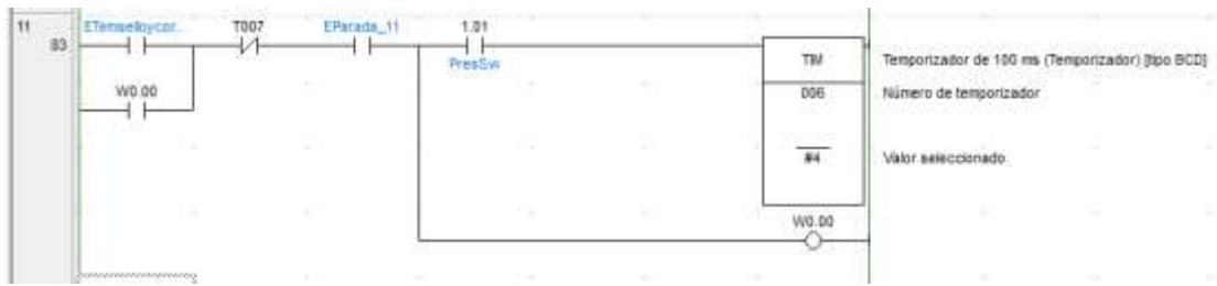
Figura 24: Activación de variable de trabajo.
