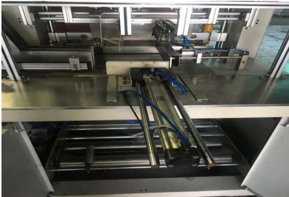
Figura 3: Pistón doble efecto de la embaladora. Fuente: Rivera A. (2023).
