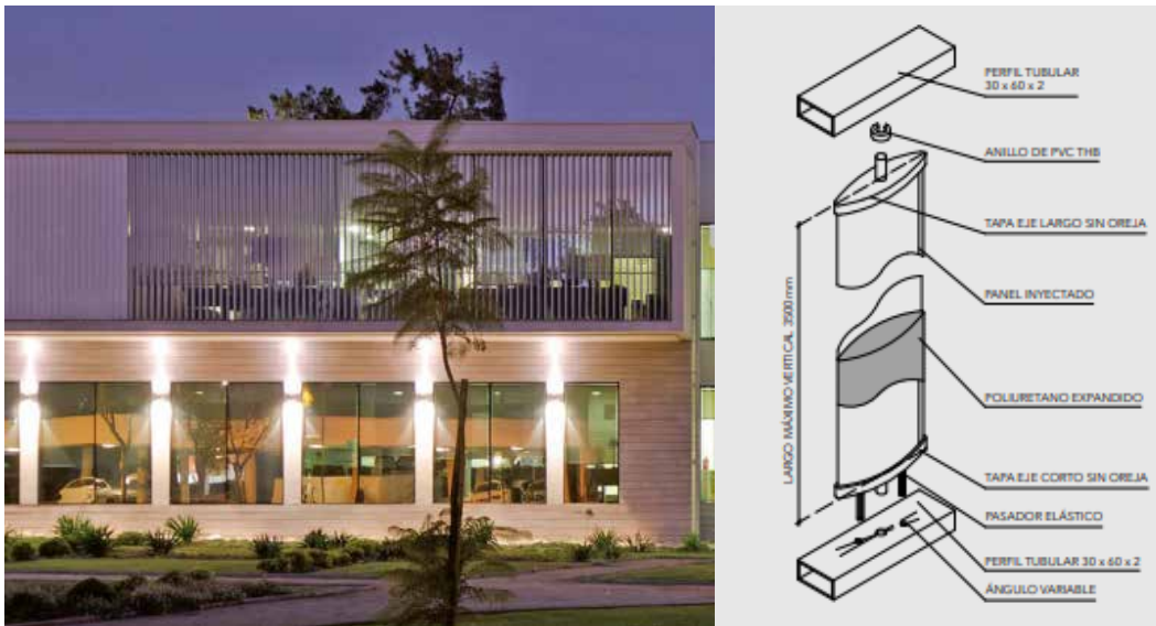
Figura 44. A la izquierda, muestra del sistema TermoBrise dispuesto de manera vertical en fachada. A la derecha, sistema de instalación de TermoBrise. (Manual de TermoBrise Hunter Douglas).
