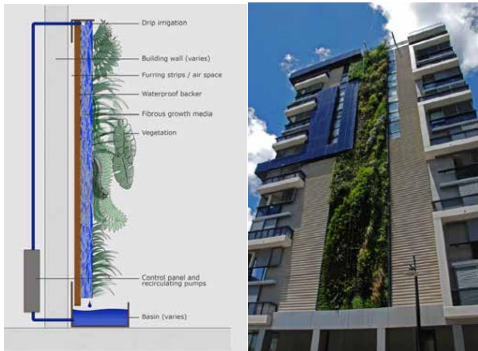
Figura 46. A la izquierda, corte transversal del sistema de instalación del jardín vertical, y a la derecha, muestra de uno de los jardines verticales de Patrick Blanc en la fachada de una edificación.
