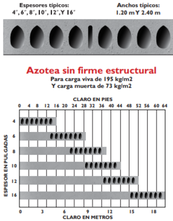
Figura 61. Detalle en corte de una lámina de Spancrete. (Manual de Spancrete Manufactures Association).
