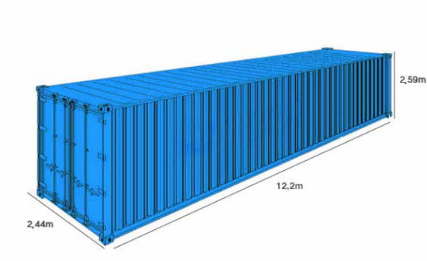
Anexo A. Dimensiones de un contenedor.
