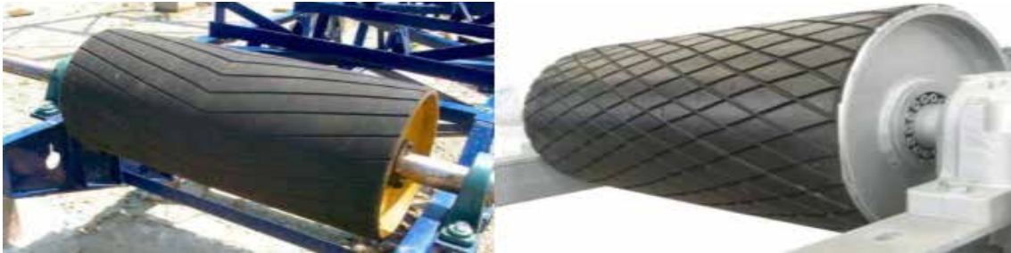
Figura 28: Tipos de engomado del tambor. Fuente: Martínez, C. (2.018).
