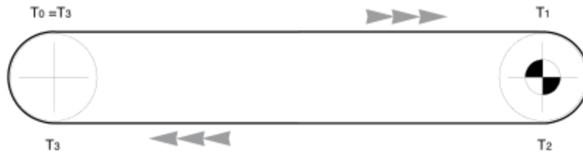
Figura 49: Tensiones presentes en la cinta transportadora. Fuente: RULMECA, (2.010).
