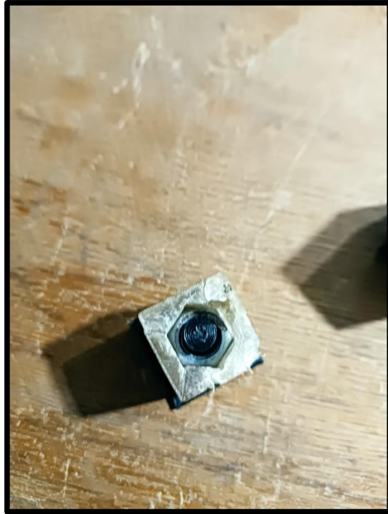
Figura 56. Tuerca entrando a molde 2 Fuente: García G., Gubaira C. (2024)
