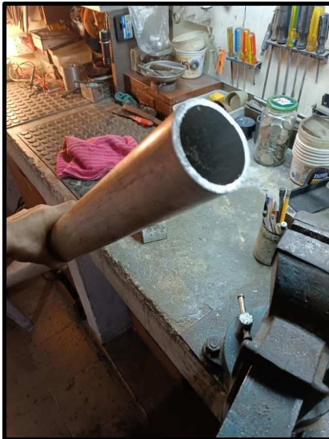
Figura 72. Tubería eléctrica de aluminio Fuente: García G., Gubaira C. (2024)
