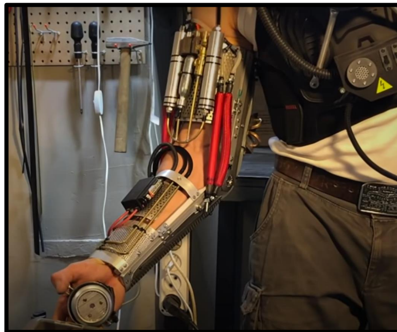
Figura 14. Exoesqueleto con músculos neumáticos Fuente: AlexLab (2021)
