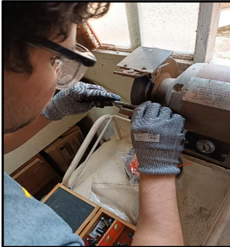
Figura 62. Desbastado de la rosca de la barra roscada
