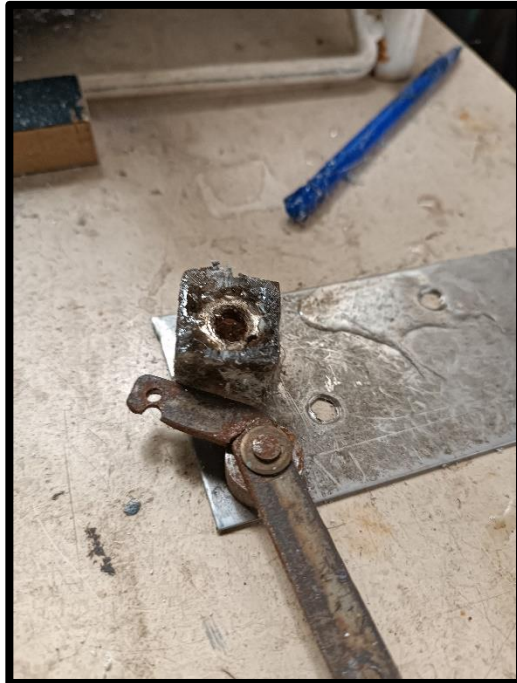
Figura 57. Moldeado de la tuerca Fuente: García G., Gubaira C. (2024)
