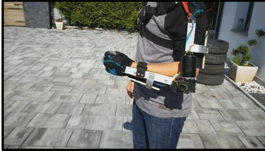
Figura 18. Exoesqueleto con motor de limpiaparabrisas
