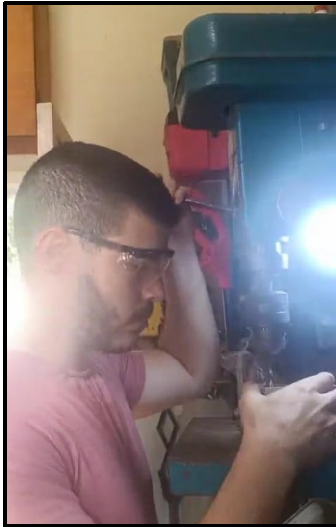
Figura 63. Taladrado de agujeros de pletinas de fijación Fuente: García G., Gubaira C. (2024)
