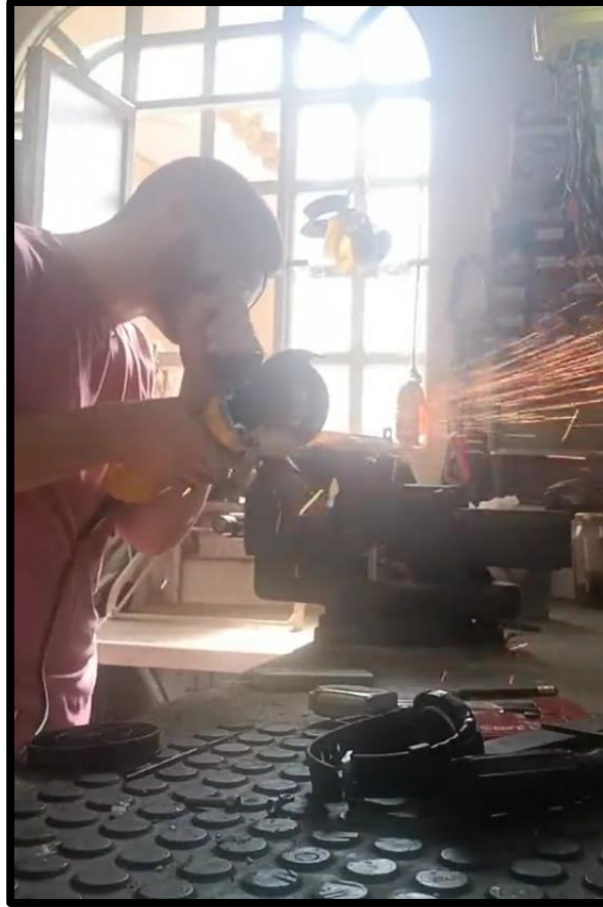
Figura 64. Corte de pletinas de fijación
