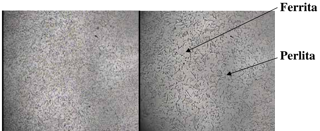
Figura 21: Microestructura del material base a 100X y 200X de aumento. Fuente: Lamus-Turipe (2018)
