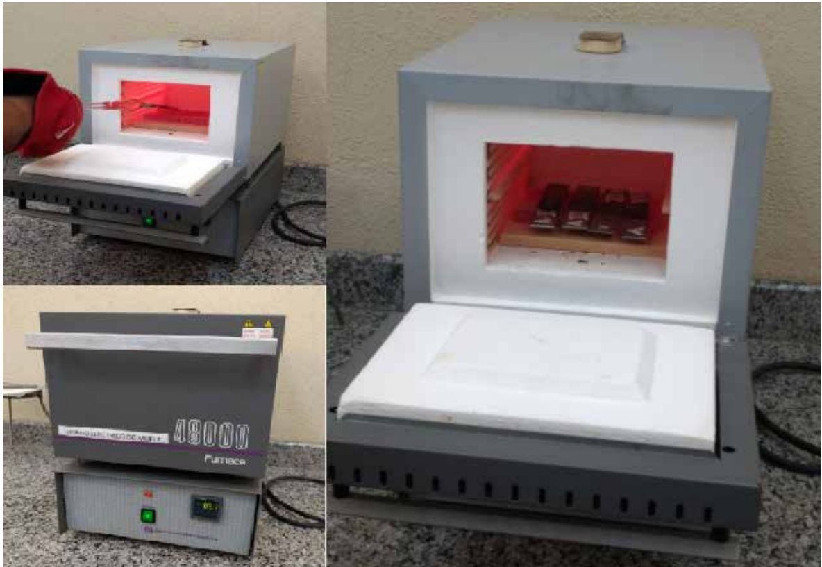
Figura 26: Tratamiento térmico a las probetas testigos. (850 °C). Fuente: Universidad José Antonio Páez Lamus-Turipe (2.018)
