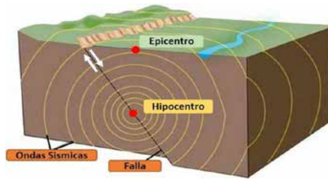
Figura 2. Componentes de un Sismo
