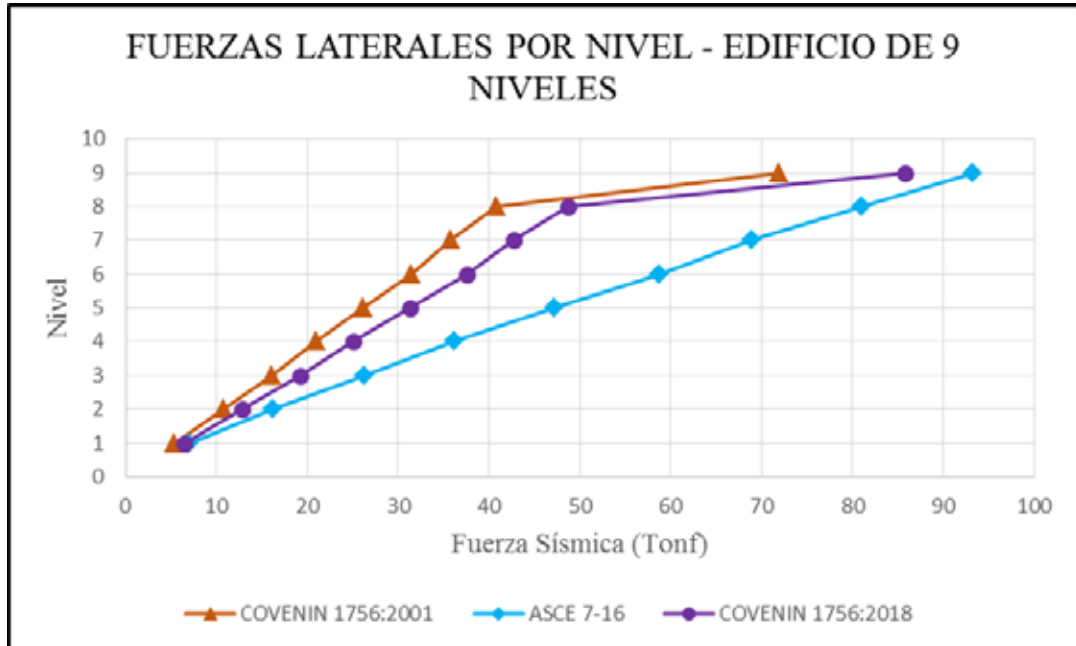
Gráfica 41. Distribución de fuerzas laterales por nivel, Edificio de 9 Niveles (Dirección X y Y).
