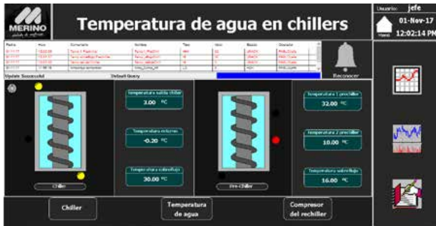
Figura 45. Pantalla de temperatura de agua en chillers
