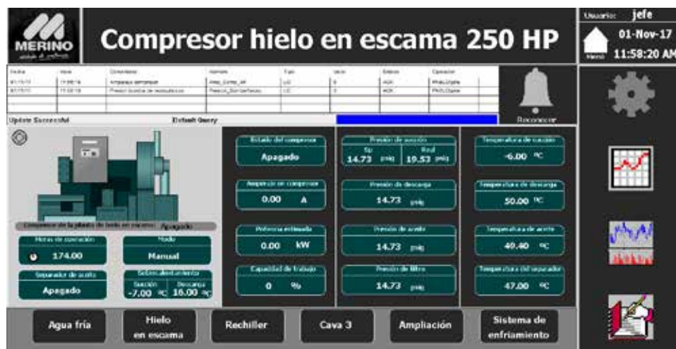
Figura 41. Pantalla del compresor para la planta de hielo en escama
