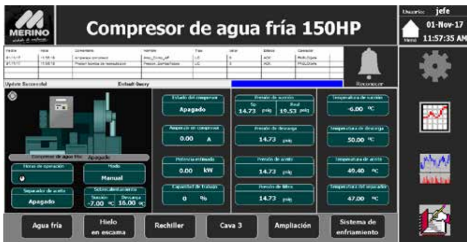
Figura 40. Pantalla del compresor para el área de agua fría
