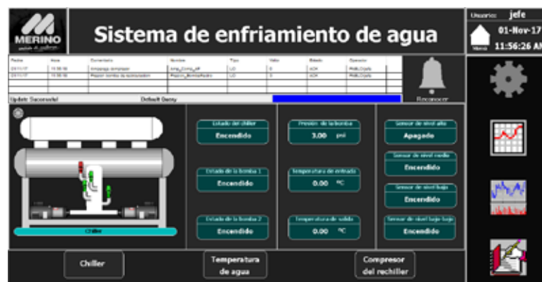
Figura 44. Pantalla del sistema de enfriamiento de agua o rechiller
