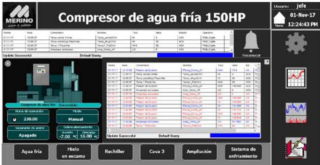
Figura 50. Ventana de histórico de alarmas
