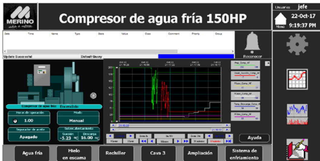
Figura 47. Pantalla de tendencia histórica para el compresor de agua fría
