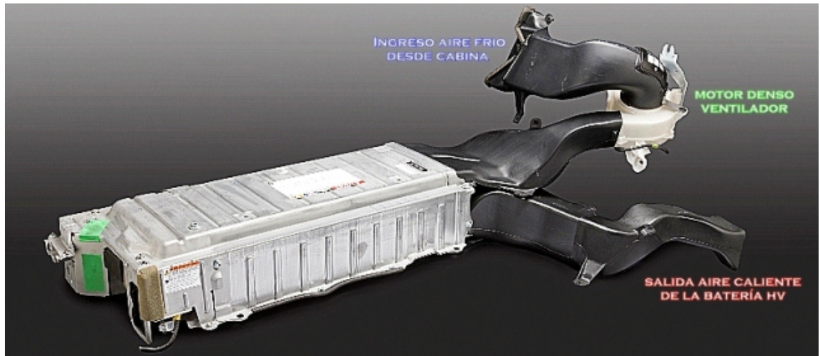
Figura 22 Ventilación para batería de Toyota Prius
