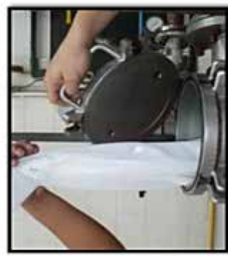
9.1.1.9 Reemplazar malla del filtro por una nueva.
