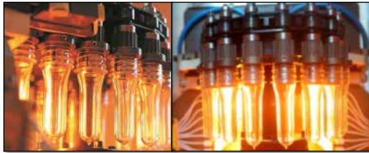
Figura 9 Rotación de la preforma por el horno de la Sopladora Autor: Fuenmayor, M. (2017).
