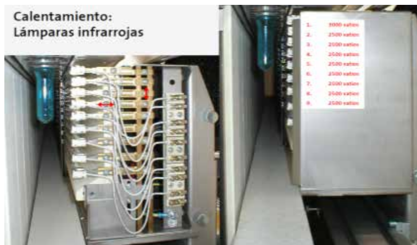
Figura 8 Posición de lámparas infrarrojas para el calentado de preforma Autor: Fuenmayor, M. (2017).
