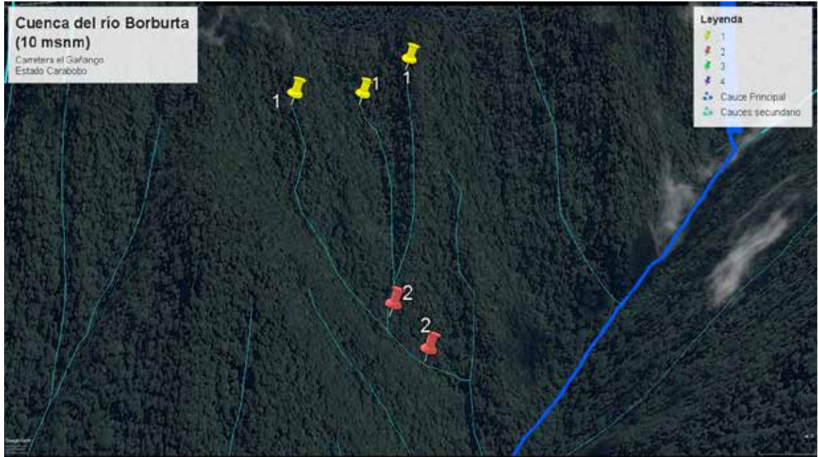
Figura 4.3 Ejemplo de asignación de orden a los cauces contribuyentes de la cuenca de río Borburata. Orden 1 con orden 2, forma orden 2.
