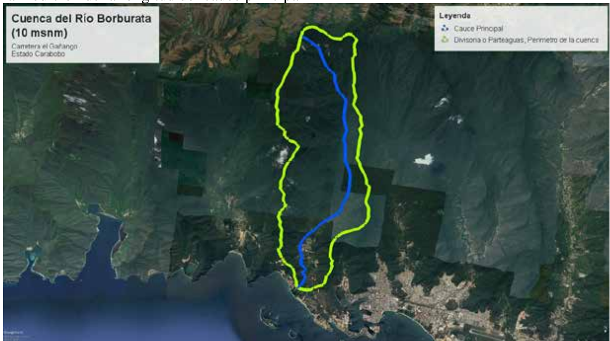
Figura 4.8 Vista de planta de la cuenca del río Borburata con su cauce principal para la medición de la longitud del cauce principal
