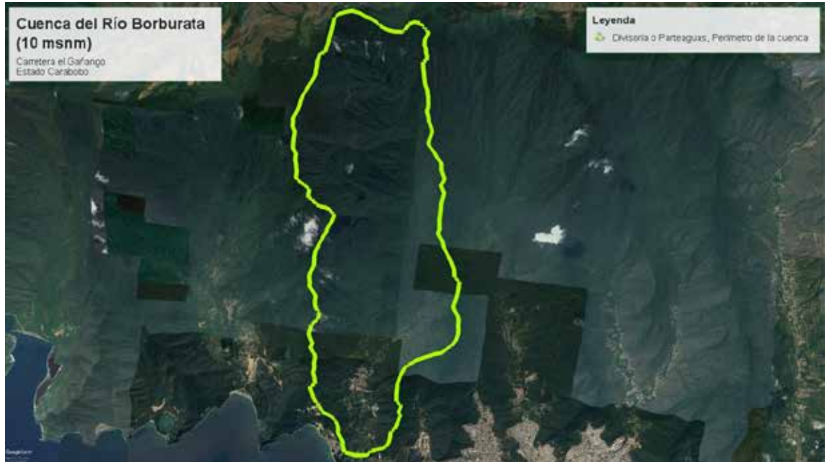
Figura 3.2 Vista de plano horizontal de la divisoria de la cuenca del río Borburata para la obtención del perímetro de la misma utilizando una herramienta digital.
