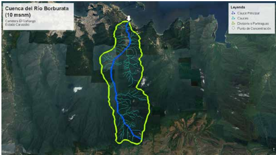
Figura 2.4.1 Vista de planta del trazado de la divisoria o parteaguas con su red de cauces
