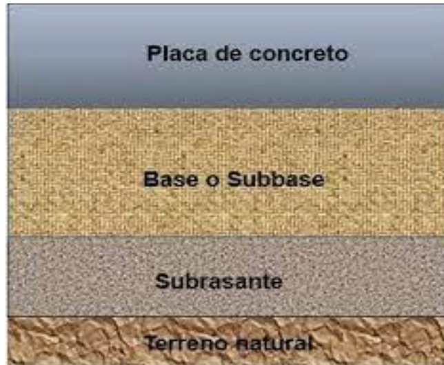
Figura 9. Estructura de pavimento rígido Fuente: (Revelo, 2019)
