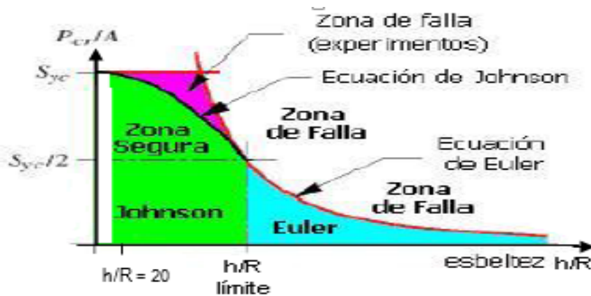
Figura 7. Representación gráfica de los criterios de Euler y Johnson para elementos de máquina largos sometidos a cargas de compresión.
