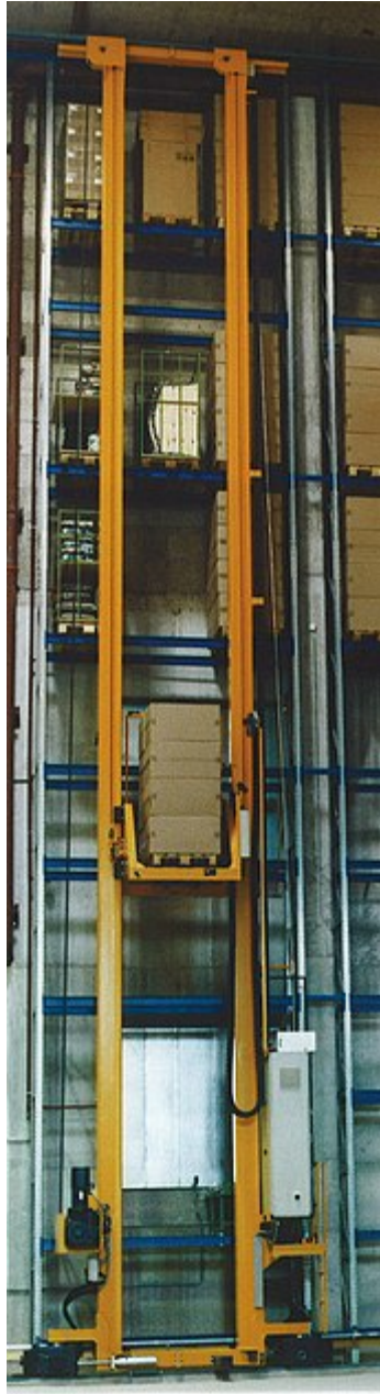
Figura 2. Sistema AS/RS con diferentes niveles de entrada.
