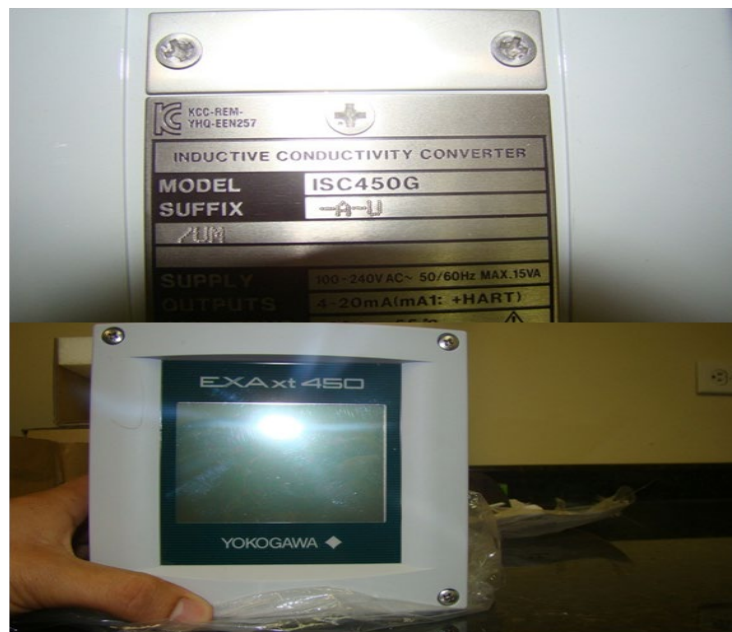
Figura 8. Transmisor Yokogawa de conductividad EXA xt 450
