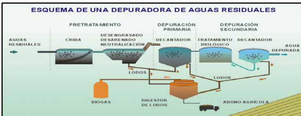
Figura 43. Esquema de Tratamiento de Aguas Residuales.
