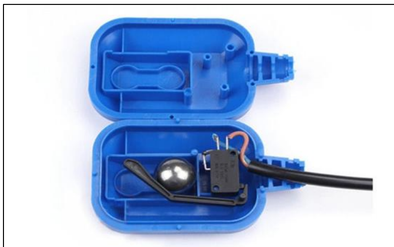
Figura 17. Sensor-interruptor flotante de nivel internamente.
