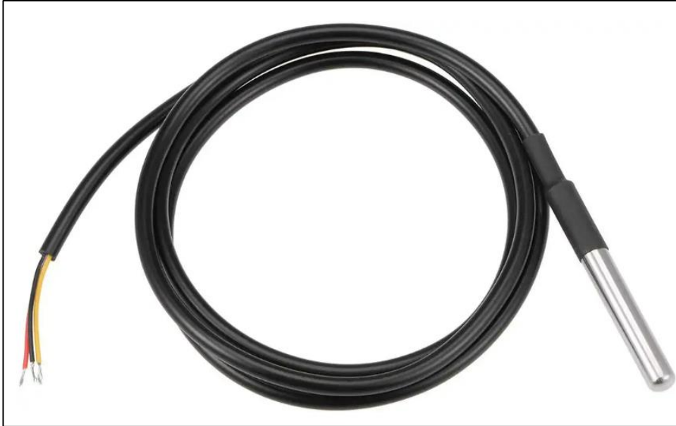
Figura 4. Sensor de temperatura sumergible DS18B20
