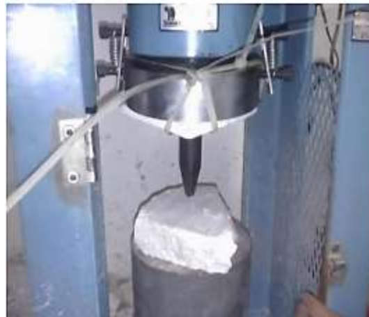
Figura 44: Ensayo de compresión 3. Fuente: Castro H. (2019).
