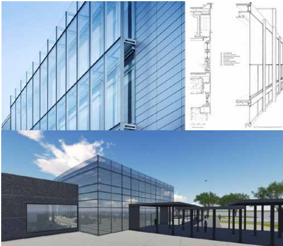
Figura 60. Curtain Wall autoportante.
