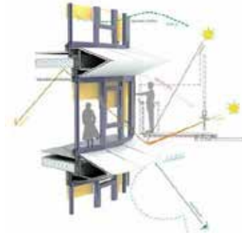
Figura 19. Funcionamiento de fachadas móviles.
