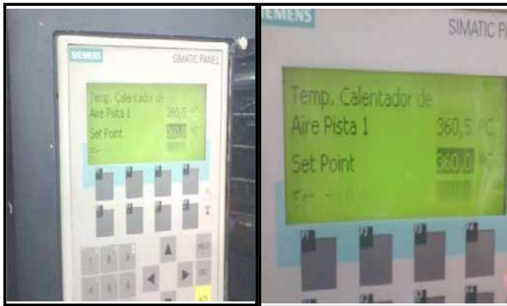
Figura 8. Pantalla o display que sirve de interfaz de comunicación entre el operador y la llenadora. Fuente: Colgate Palmolive Cuidado Bucal. (2019)
