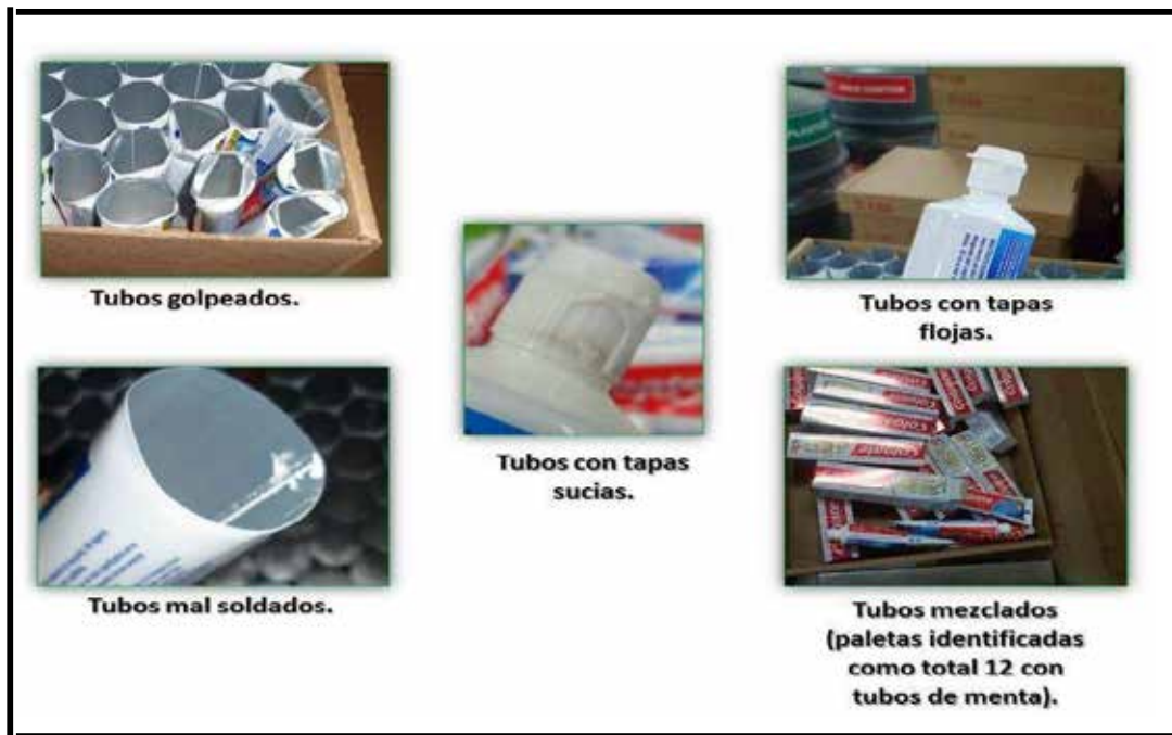
Figura 18. Defectos más comunes provenientes de la planta de tubos. Fuente: Colgate Palmolive Cuidado Bucal. (2019)
