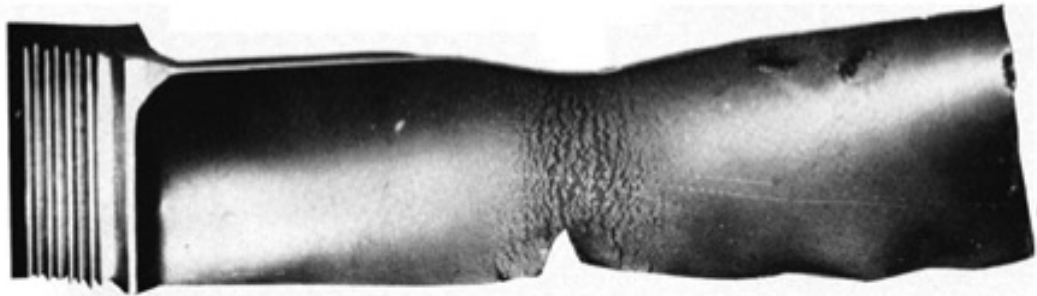
Figura 50 Deformación por termofluencia en álabe.
