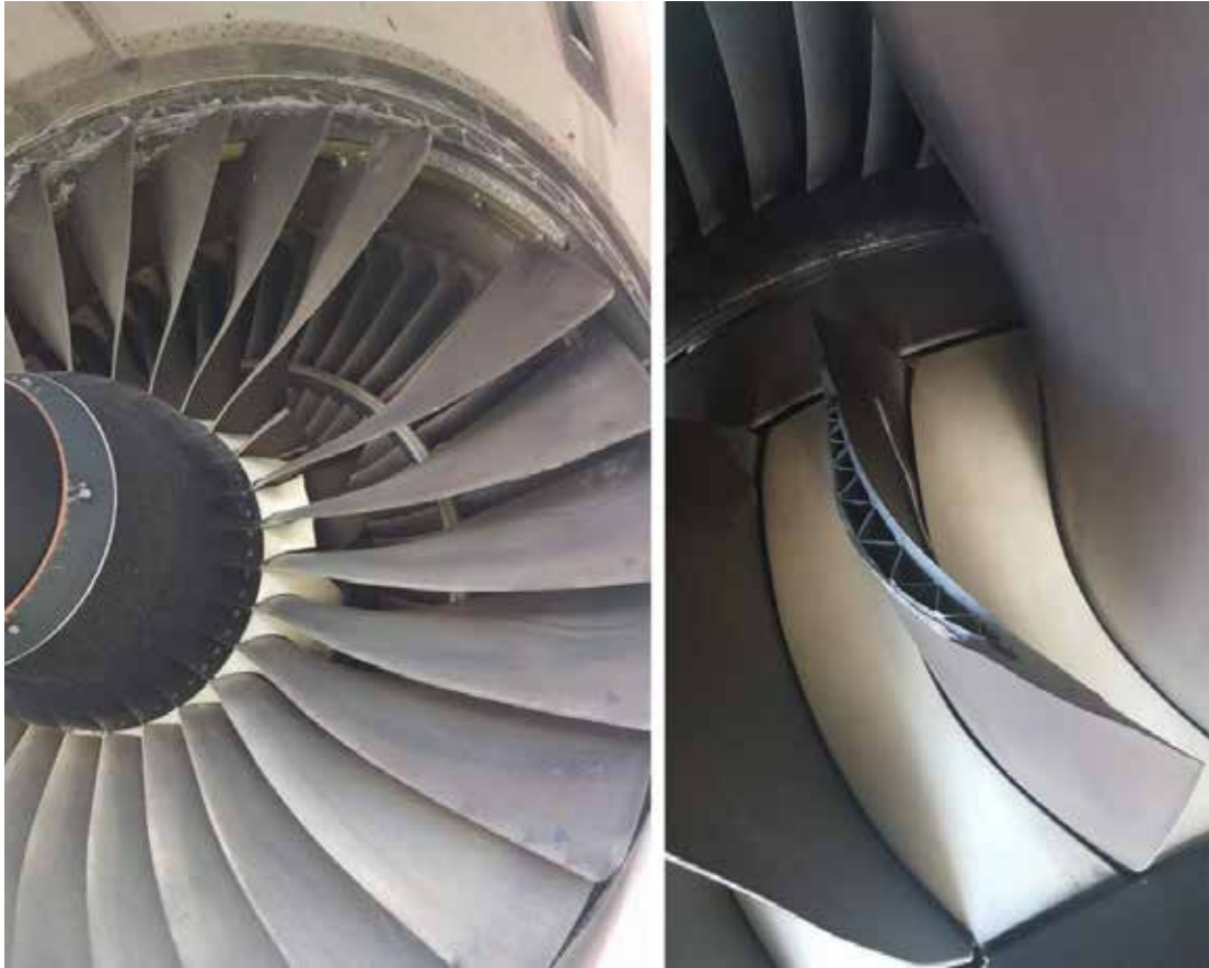
Figura 46 Falta de un álabe en el fan
