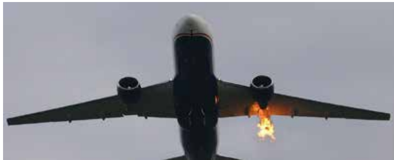
Figura 47 Llamas por el sistema de escape debido al Surge Fuente: Edward Waite
