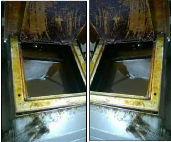
Figura 6: Tanques de retención del Adhesivo HM Fuente: Nestlé Venezuela SA (2018).
