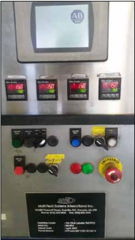
Figura 10: Tablero de control de etiquetadora Hot gluelabeler 960 PCD. Fuente: Nestlé Venezuela SA (2018).
