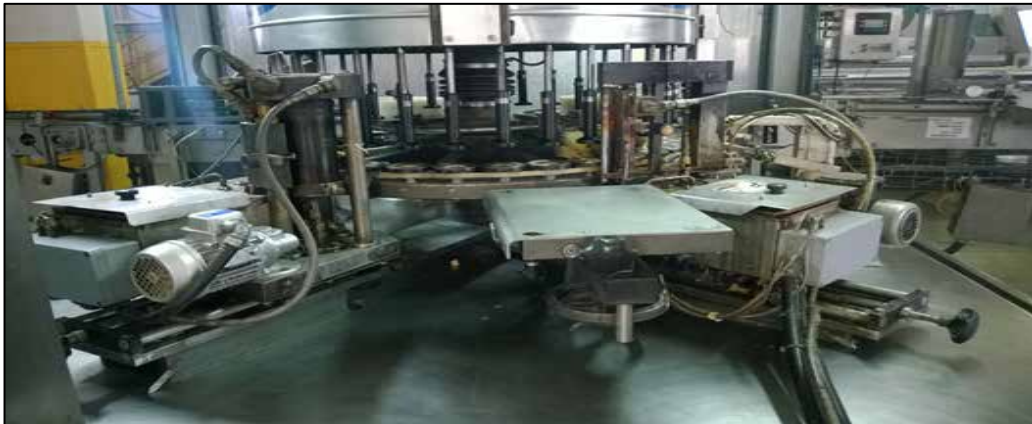
Figura 3: Cuerpo o Carrusel etiquetadora. Fuente: Nestlé Venezuela SA (2018).
