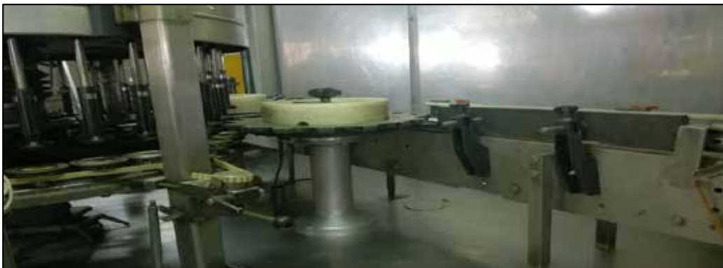
Figura 4: Cuerpo o Carrusel etiquetadora. Fuente: Nestlé Venezuela SA (2018).
