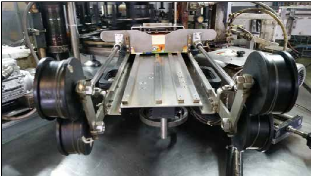
Figura 4: Cuerpo o Carrusel etiquetadora. Fuente: Nestlé Venezuela SA (2018).
