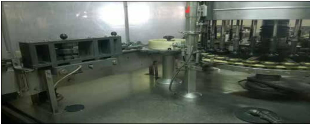
Figura 2: Estrella de entrada etiquetadora. Fuente: Nestlé Venezuela SA (2018).
