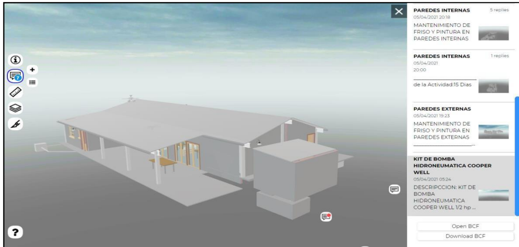
Figura 42: Visualización de la vinculación de las partidas Revit con el visor Tridify.
