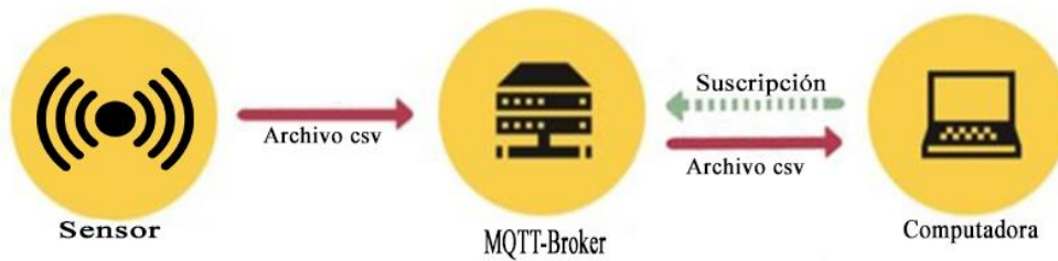
Figura 15 Diagrama transmisión de protocolo MQTT
