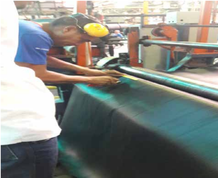
Figura 34. Método de corte en Cameron de goma.
