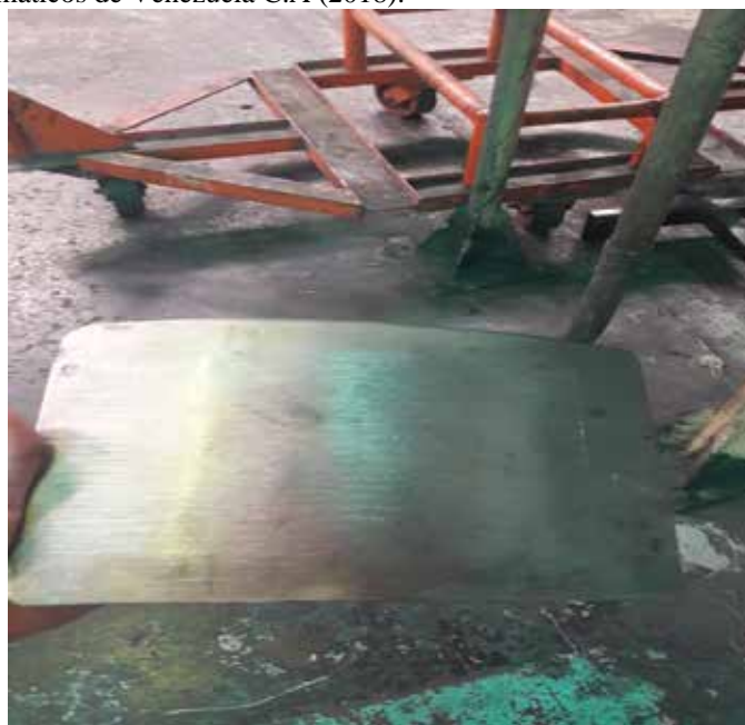
Figura 19. Herramienta tipo plancha para fijar Empate del material Fuente: Alice Neumáticos de Venezuela C.A (2018).
