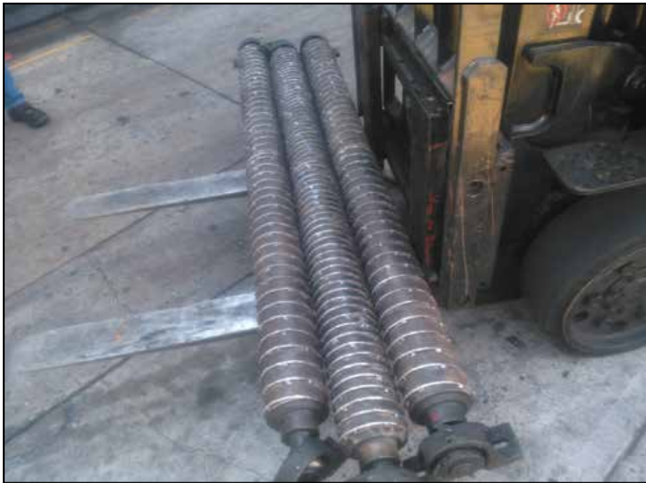
Figura 27. Rodillos saca arrugas para Liners. Fuente: Alice Neumáticos de Venezuela C.A (2018).
