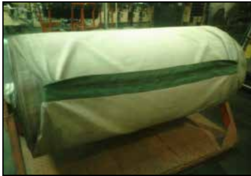
Figura 29. Liners para Calandra propuesto en buen estado. Fuente: Alice Neumáticos de Venezuela C.A (2018).
