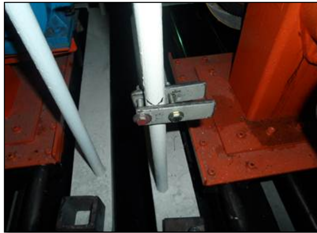
Figura 33. Freno de bobinado de Spiral Layer Slitter. Fuente: Alice Neumáticos de Venezuela C.A (2018).
