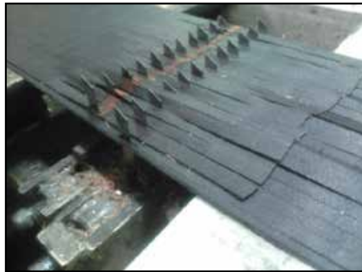
Figura 23. Empate de un material a otro en Spiral Layer Slitter.
