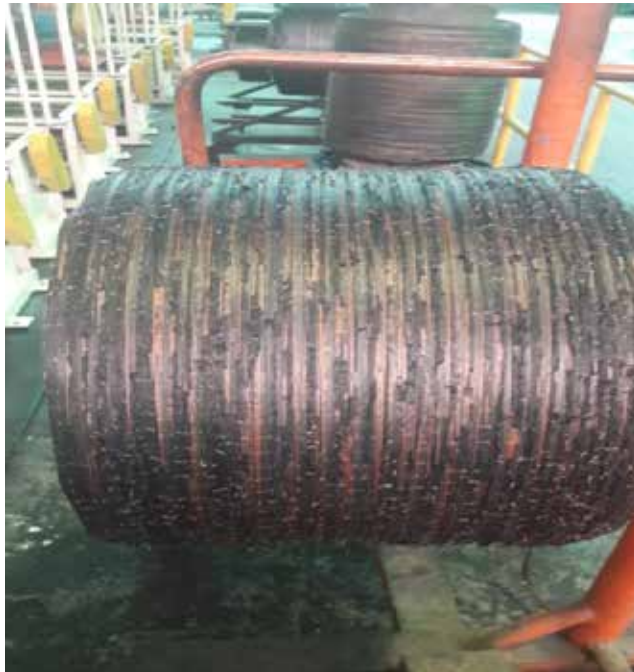
Figura 13. Hilos visibles por falta de Skin.
