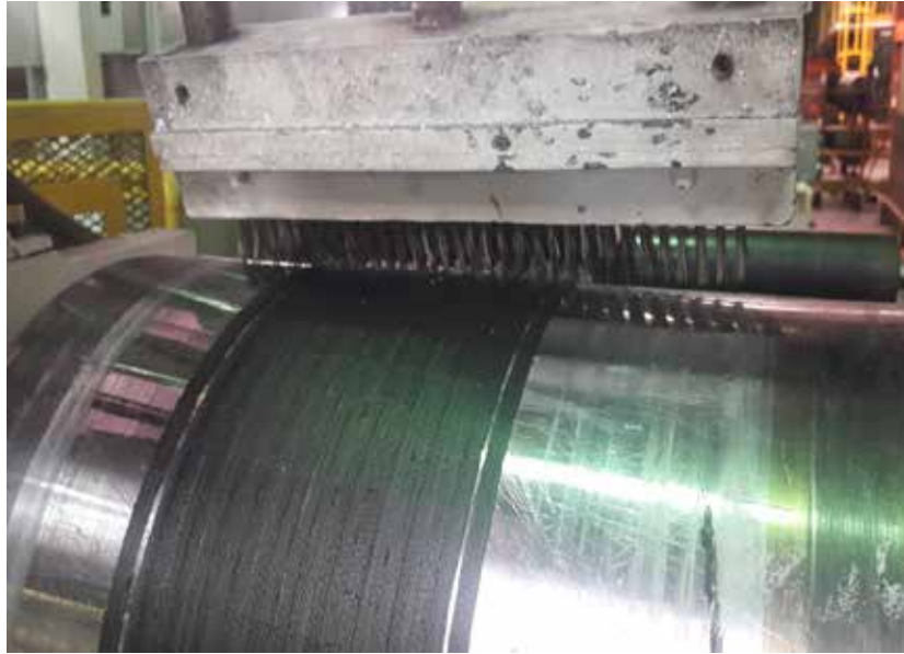
Figura 31. Cepillo pisador de Spiral Layer Slitter.
