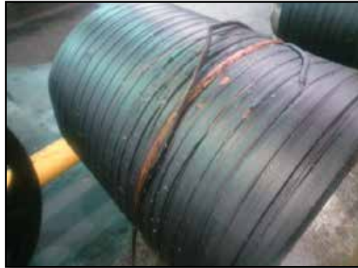
Figura 16. Generación de Vena por falla en Método de Empate Fuente: Alice Neumáticos de Venezuela C.A (2018).
