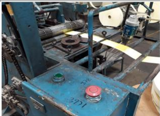
Los botones de arranque y control no se encuentran debidamente identificados.
