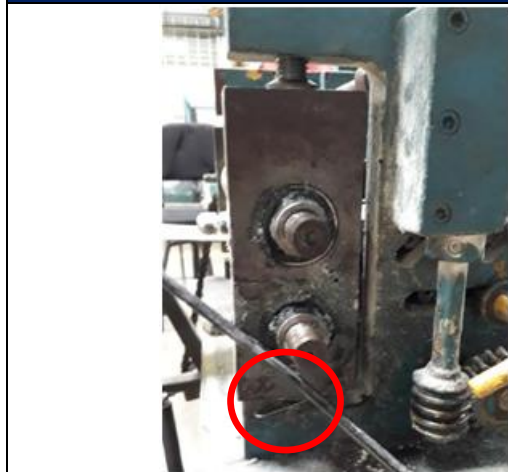
Suplemento utilizado por desajuste en la plisadora.
