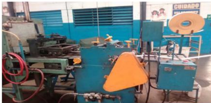
Figura 7. Plisadora del papel filtrante
