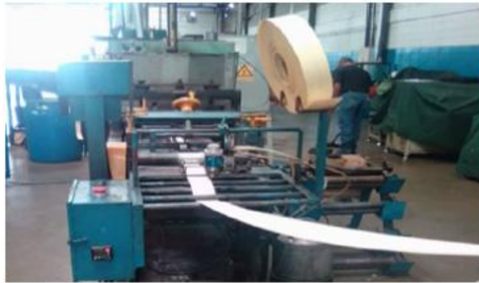
Figura 6. Plisadora del papel filtrante
