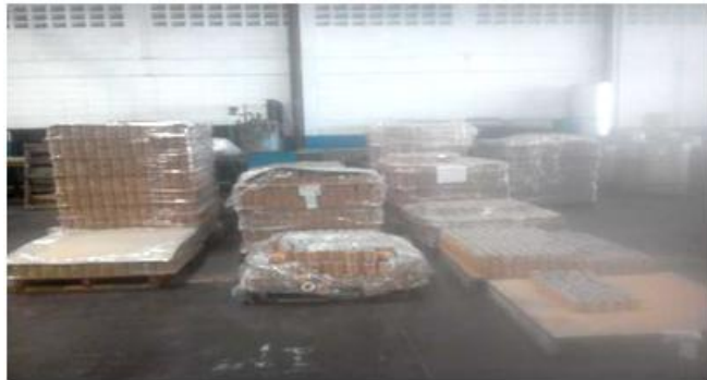
Área destinada para la preservación de los elementos filtrantes se observan paletas de elemento filtrante mal preservado, mal distribuido y mal envuelto
