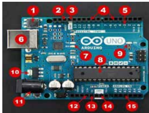
Figura 1: Componentes de un Arduino Uno
