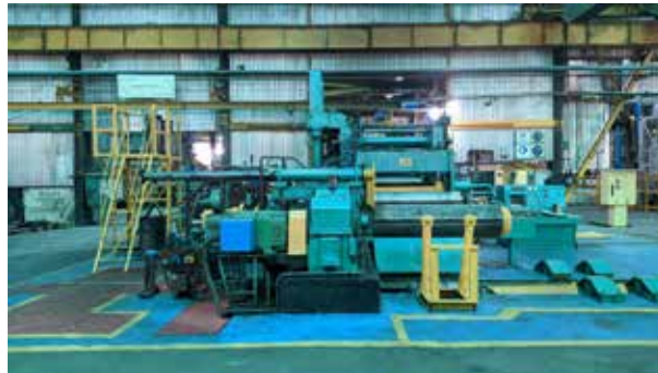
Figura 22: Máquina de colada JUMBO 3C840.
