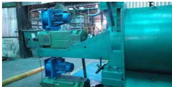
Figura 24: Motores de cilindros de solidificación y laminación.
