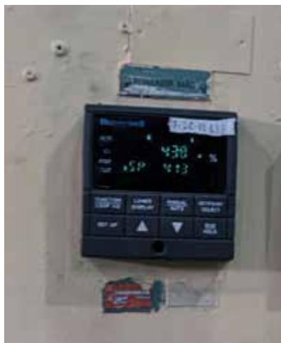
Figura 37: Lectura de temperatura de horno de fundición con el Honeywell.
