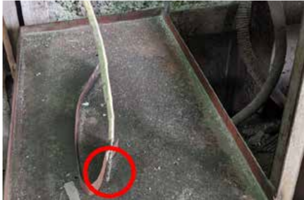
Figura 26: Termocupla tipo K del horno de fundición.
