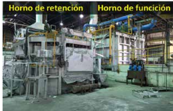
Figura 21: Hornos de fundición y de retención.
