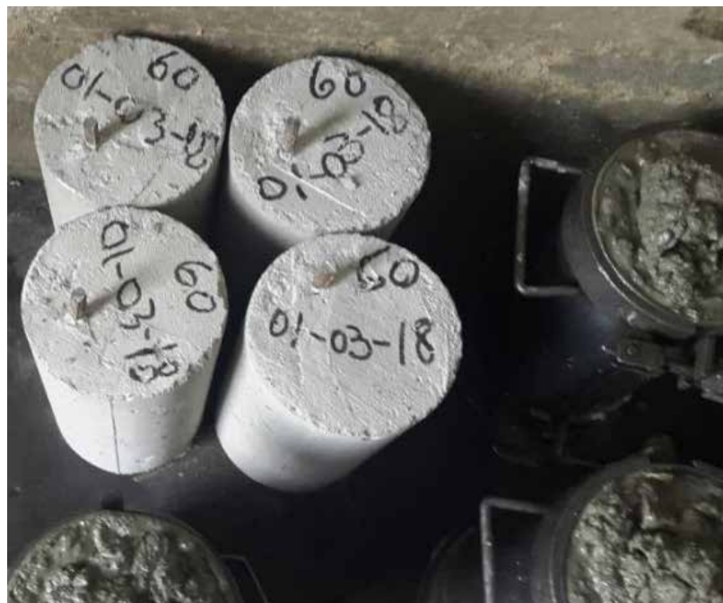
Figura 12. Proceso de medición de voltaje de los cilindros de concreto.
