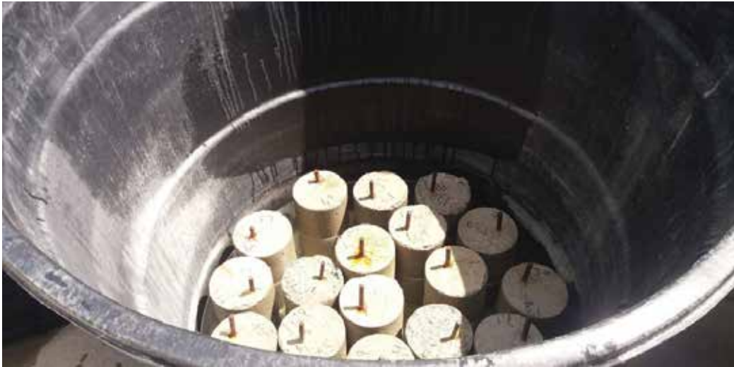
Figura 7. Tanque 1 Solución al 3% de NaCl.
