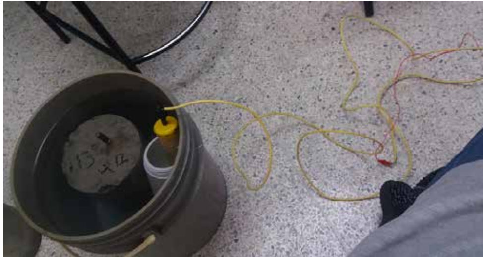
Figura 10. Electrodo de referencia, cobre sulfato de cobre sumergido en el recipiente junto al cilindro de concreto. Midiendo voltaje, potencial de corrosión.
