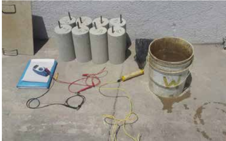
Figura 12. Proceso de medición de voltaje de los cilindros de concreto.
