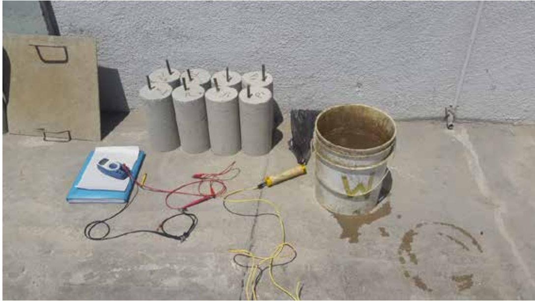
Figura 5 Medición de voltaje de las probetas
