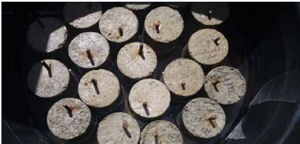
Figura 9. Tanque 3 Solución al 5% de NaCl.
