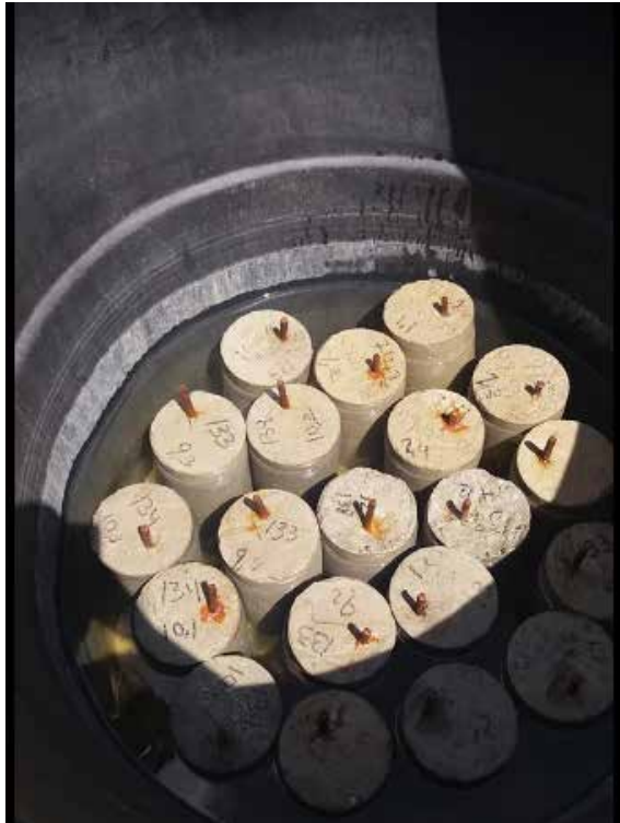
Figura 8. Tanque 2 Solución al 4% de NaCl.
