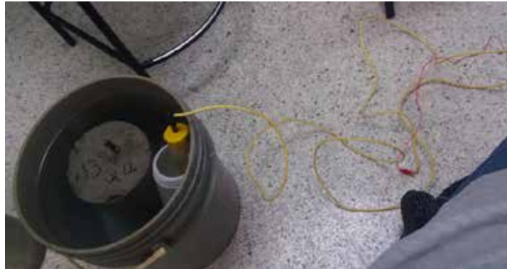
Figura 6 Medición de voltaje de las probetas
