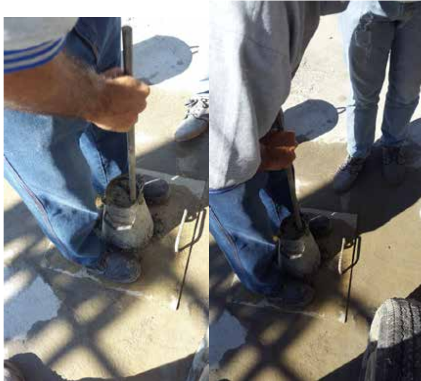
Figura 2. Ensayo de asentamiento, trabajabilidad, fraguado
