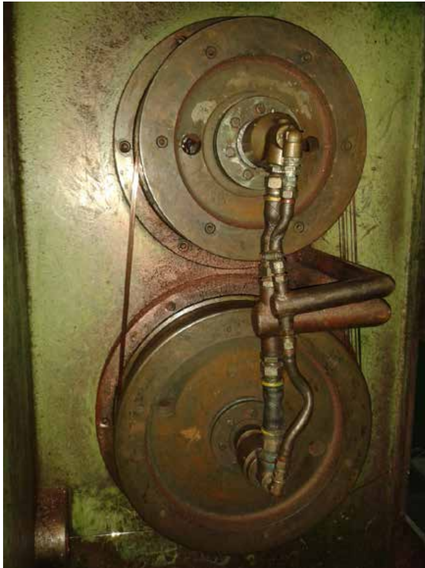
Capstan motor 15 de trefiladora
